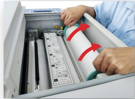
4 ) Поднимите металлический направляющий ролик
