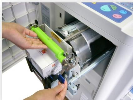
4 ) Возьмитесь одной рукой за ручку барабана, а второй за металлическую ось, расположенную над барабаном – аккуратно извлеките барабан из устройства
