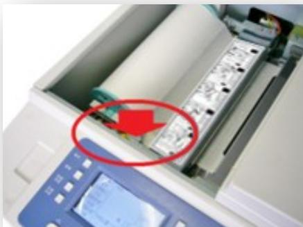
a: Рычаг прижима термоголовки
