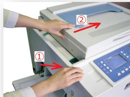
2 ) Переведите рычаг прижима термоголовки в положение открыто.
