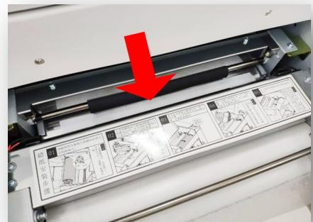
9 ) Переведите рычаг прижима термоголовки в положение закрыто.
