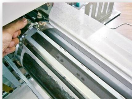
6 ) Разблокируйте барабан с помощью свитча, поверните немного против часовой стрелки.
