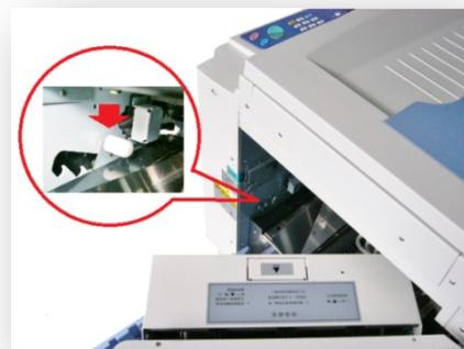
Регулировка плотности печати осуществляется путем перемещения рычага управления. Существует 3 позиции рычага:
